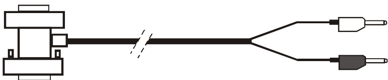
KABEL F1*: Zasilanie UTP-10 z zasilacza zewn. 6-28 V DC oraz podłączenie drukarki kablem RS-232 ( stosowany zamiennie z F)
