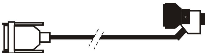
KABEL E*: Czujnik fotooptyczny z uchwytem magnetycznym AOP-funkcja automatycznego START-u i STOP-u
