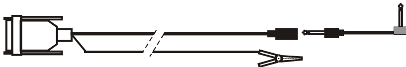
KABEL B+B1: pomiar stałej k tachografu, współczynnika w, testy TV;TL;Pv przez gniazdo Jack tachografu
